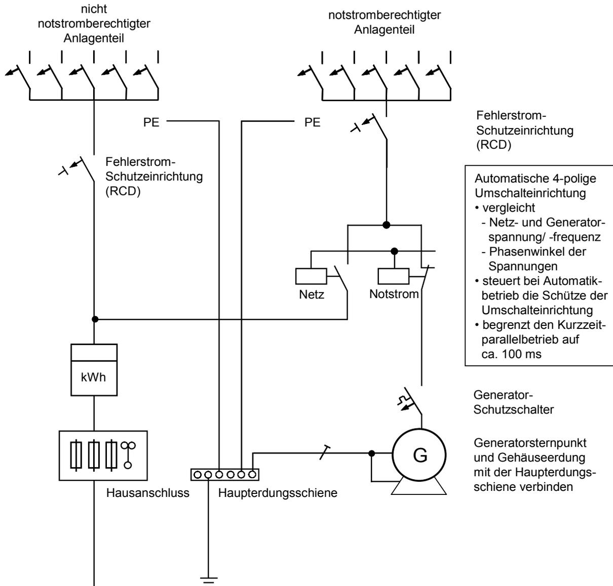
Anlage nur teilweise notstromberechtigt. Der notstromberechtigte Anlagenteil wird während des Generatorbetriebes als TN-S-System mit Schutz durch automatische Abschaltung betrieben (keine Trennung von Anlagen- und Betriebserder möglich).
