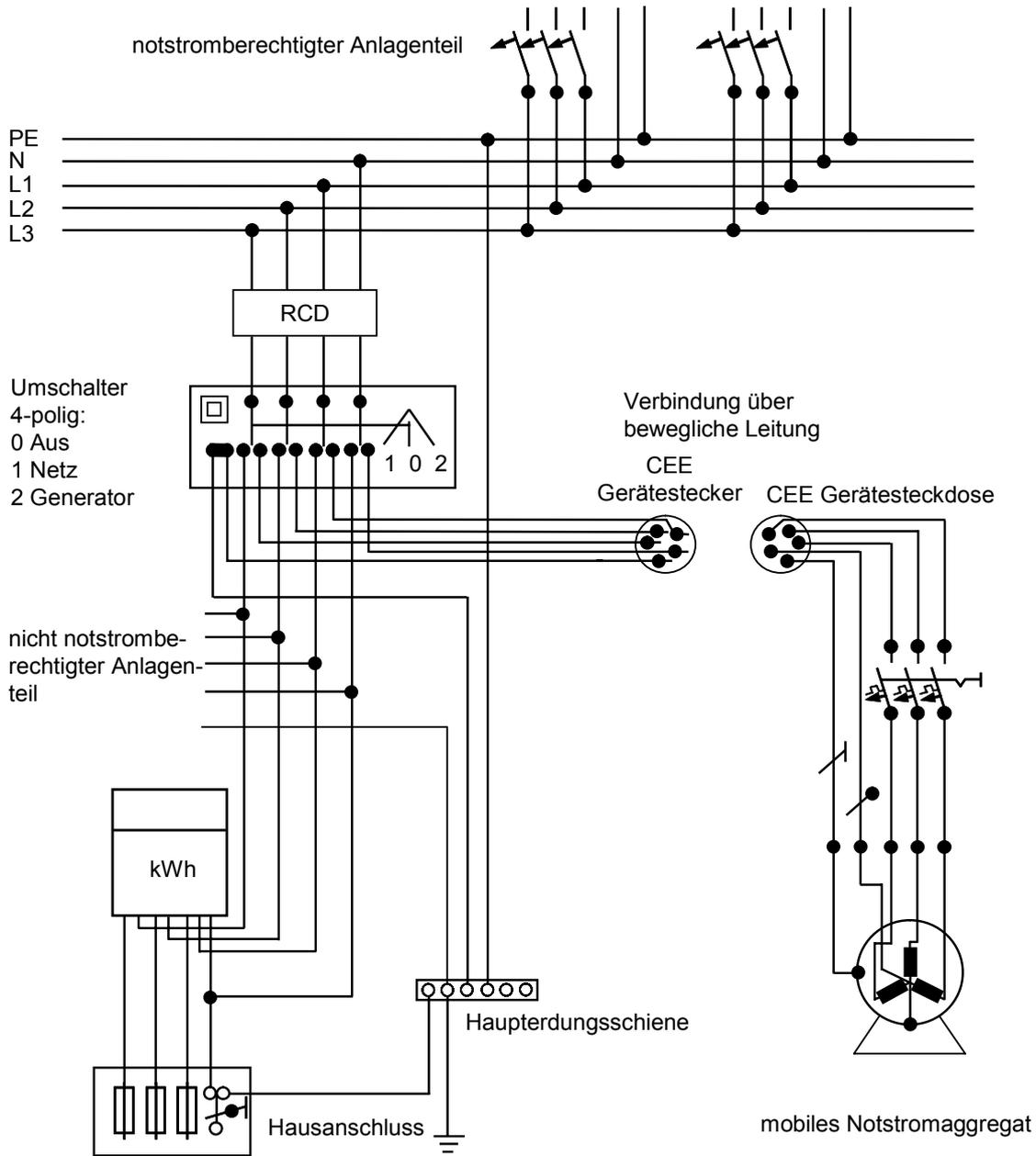
Anlage nur teilweise notstromberechtigt. Der notstromberechtigter Anlagenteil wird als TN-S-System betrieben (siehe Abschnitt 5 Erläuterungen).
