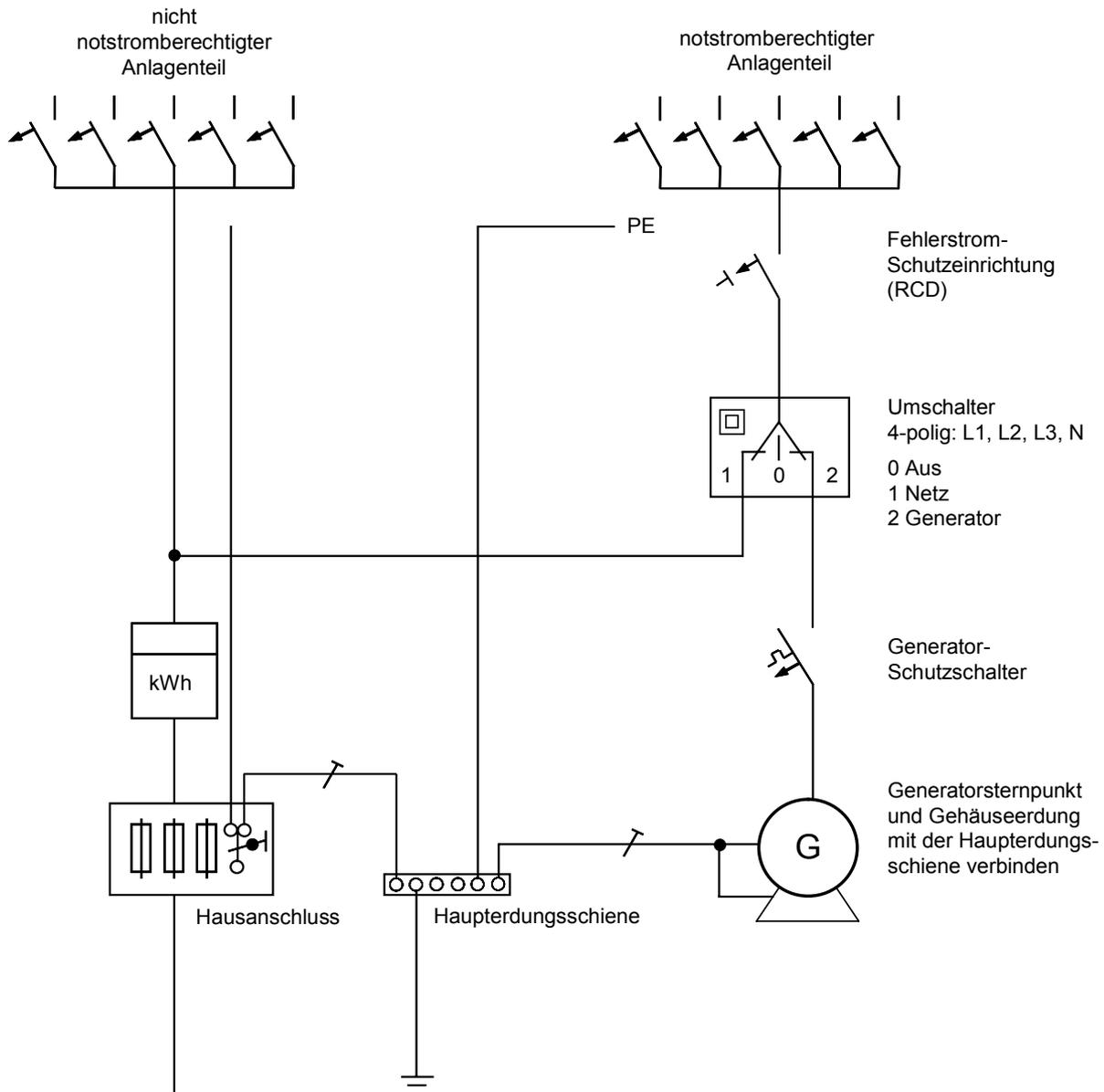
Anlage nur teilweise notstromberechtigt. Der notstromberechtigte Anlagenteil wird als TN-S-System betrieben (siehe Abschnitt 5 Erläuterungen).
