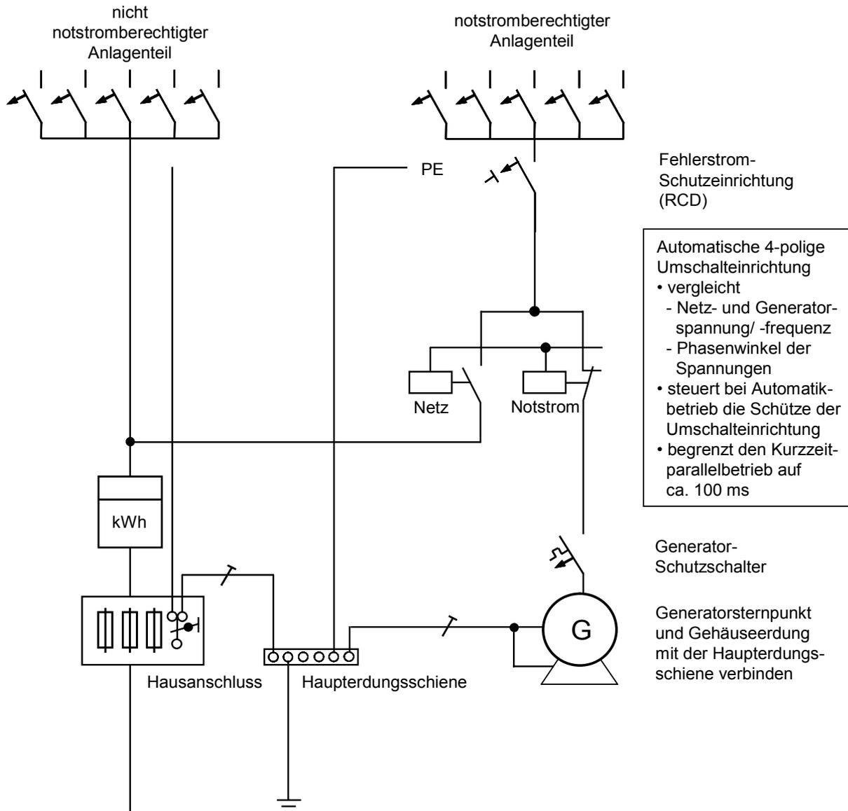
Anlage nur teilweise notstromberechtigt. Der notstromberechtigte Anlagenteil wird als TN-S-System betrieben (siehe Abschnitt 5 Erläuterungen).
